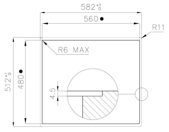
• Built-in cut out for FTS - Foratura per installazione FTS
